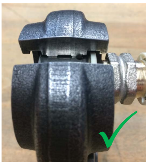
Správné usazení čelisti na lisovacím fitinku
