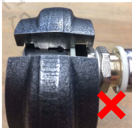
Špatné usazení čelisti na lisovacím fitinku
